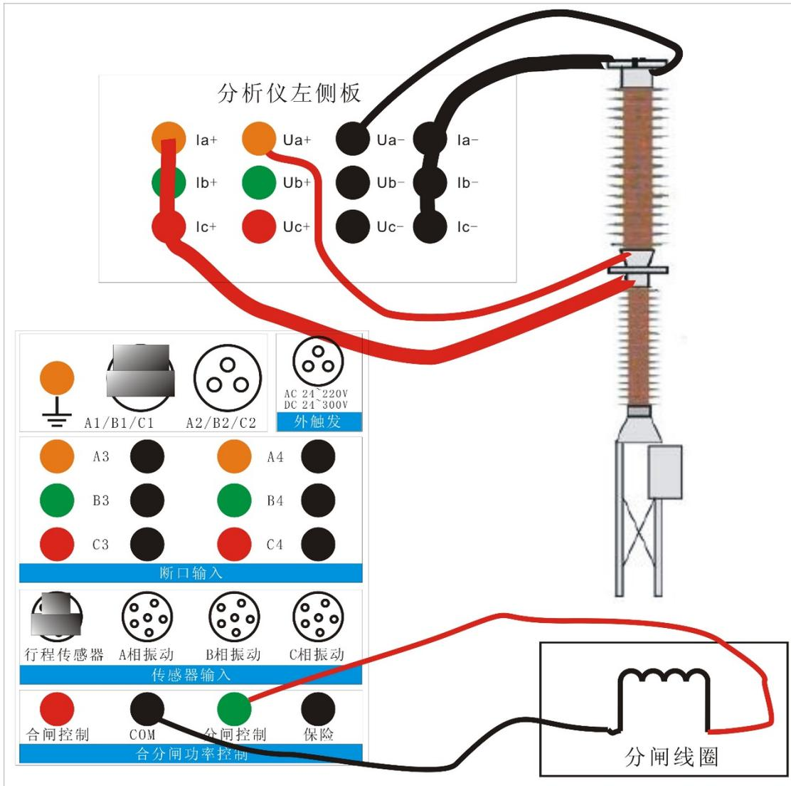
图 4.6 使用内电源时断路器动态电阻试验
