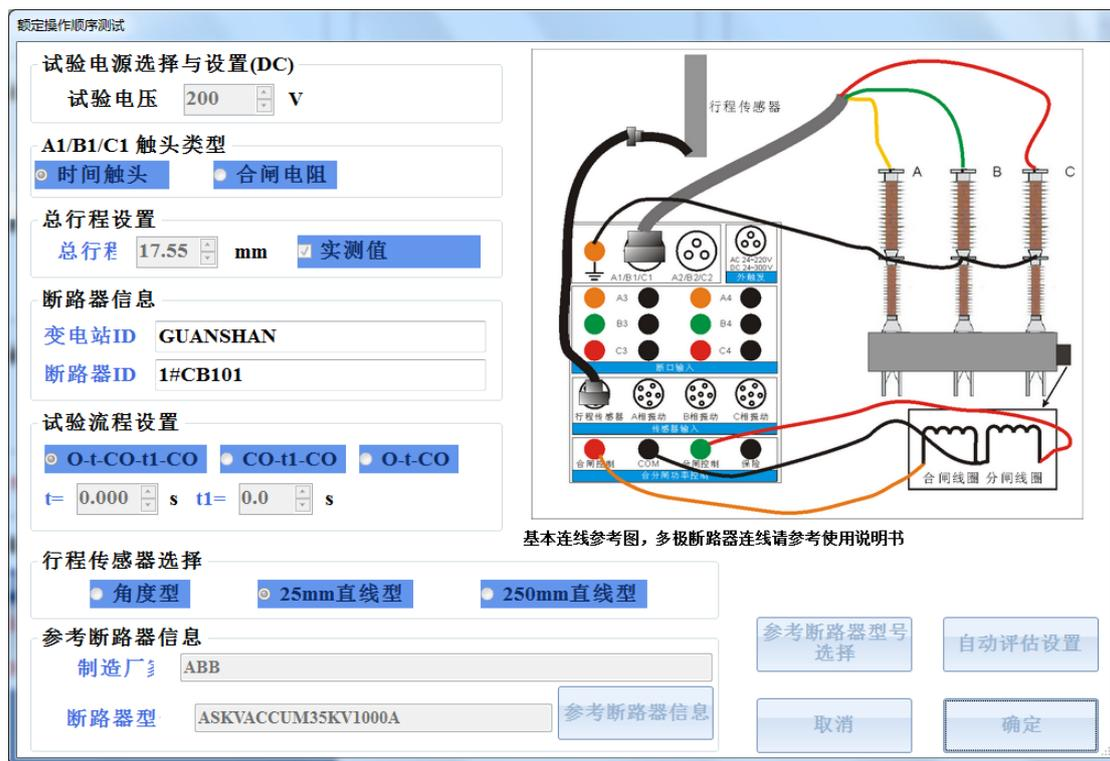
图 6.8 额定操作序列试验参数设置
