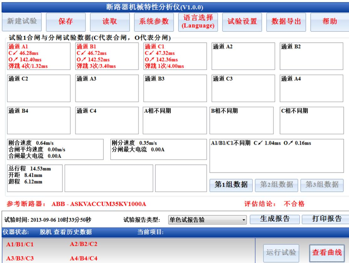
图 6.7 循环试验测试结果
