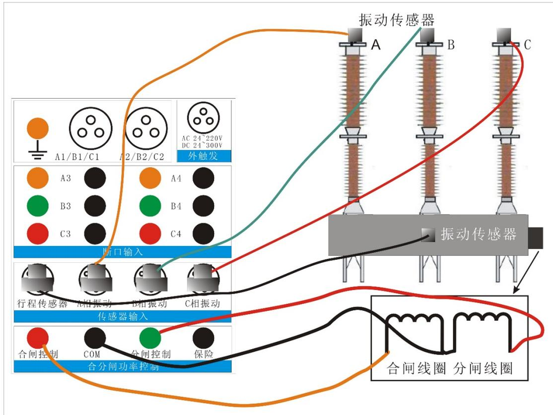
图 4.7 断路器振动试验连线图
