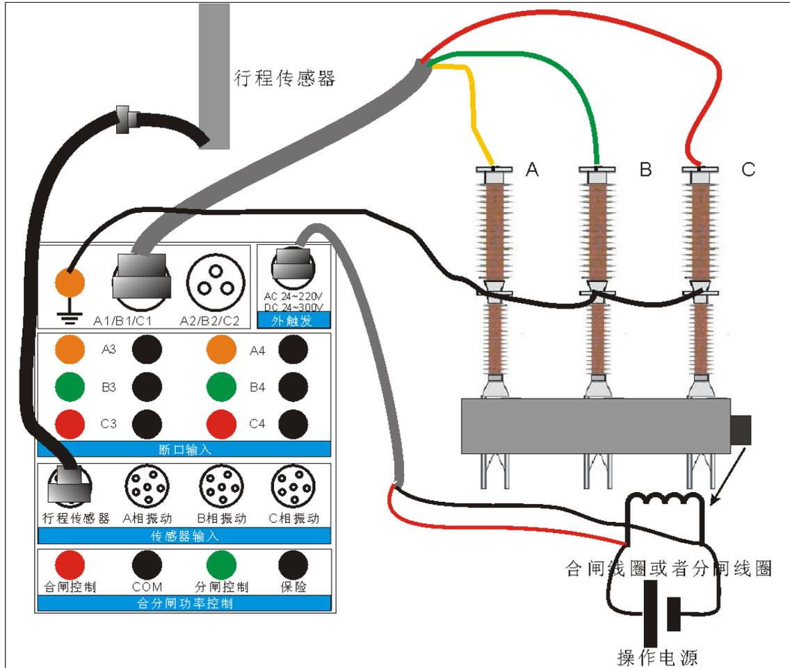
图 4.3 外触发合闸与分闸试验连线图
