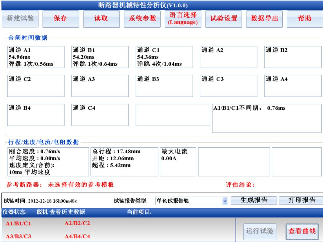
图 6.3 合闸试验测试结果
