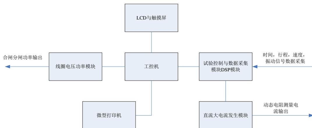
图 2.2 断路器分析仪内部原理图
