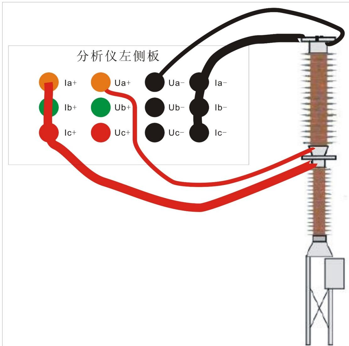
图 4.5 回路电阻测量接线图
