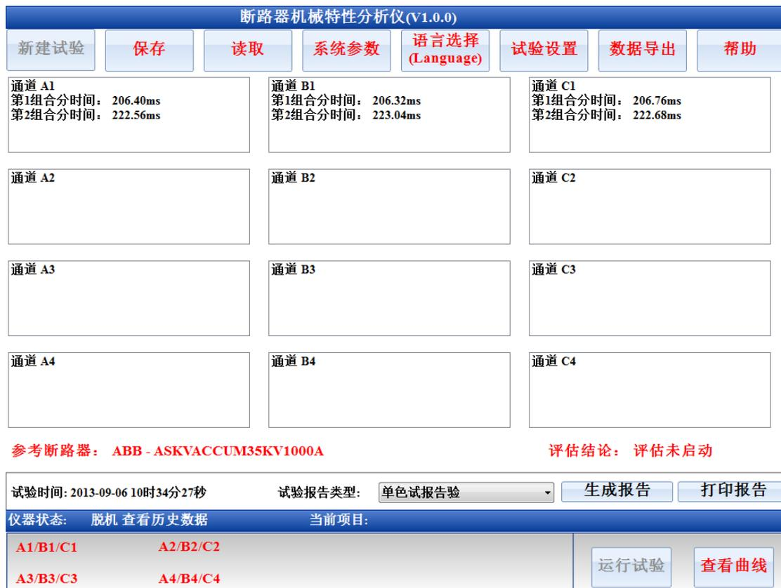
图 6.9 额定操作序列试验测试结果
