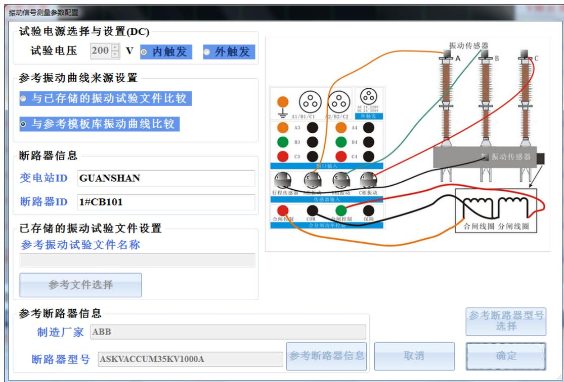
图 6.12 断路器振动试验参数设置
