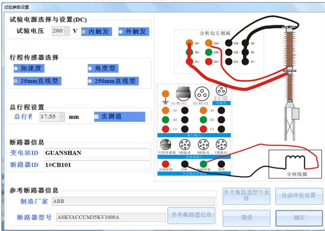
图 6.10 额定操作序列试验参数设置
