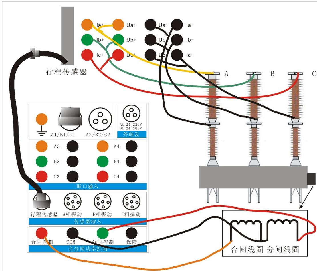
图 4.4 石墨触头断路器测试连线
