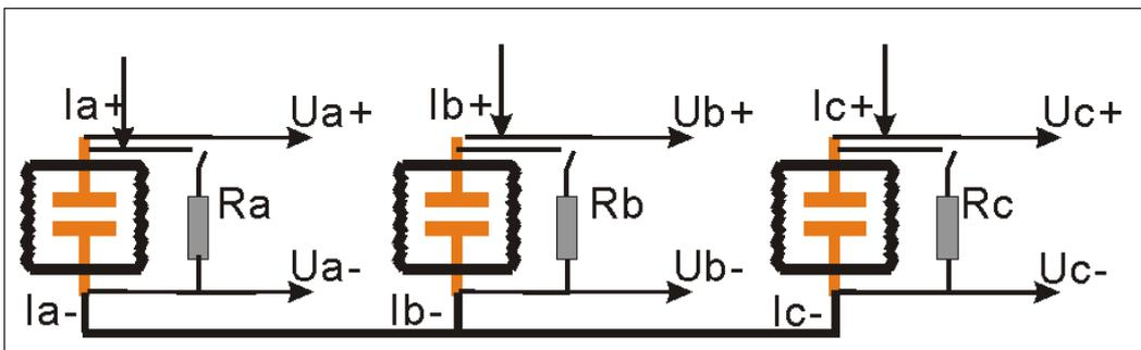
图 3.3 石墨触头测量回路工作原理
