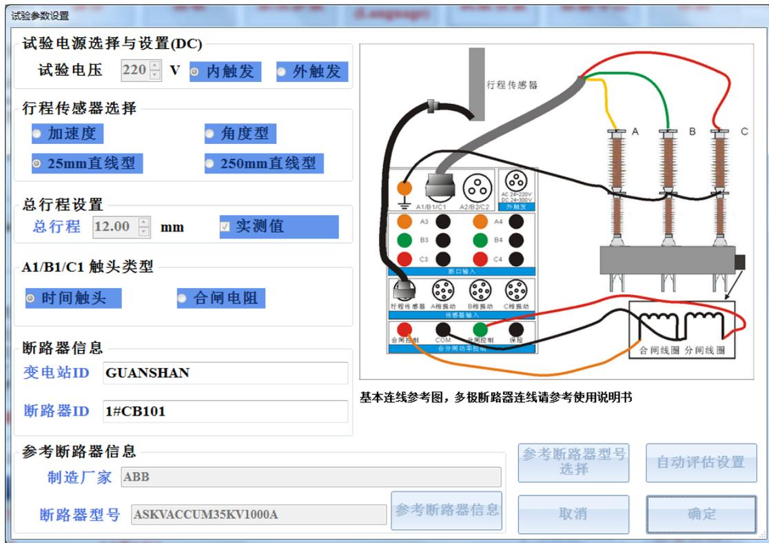
图 6.1 断路器合闸试验参数设置
