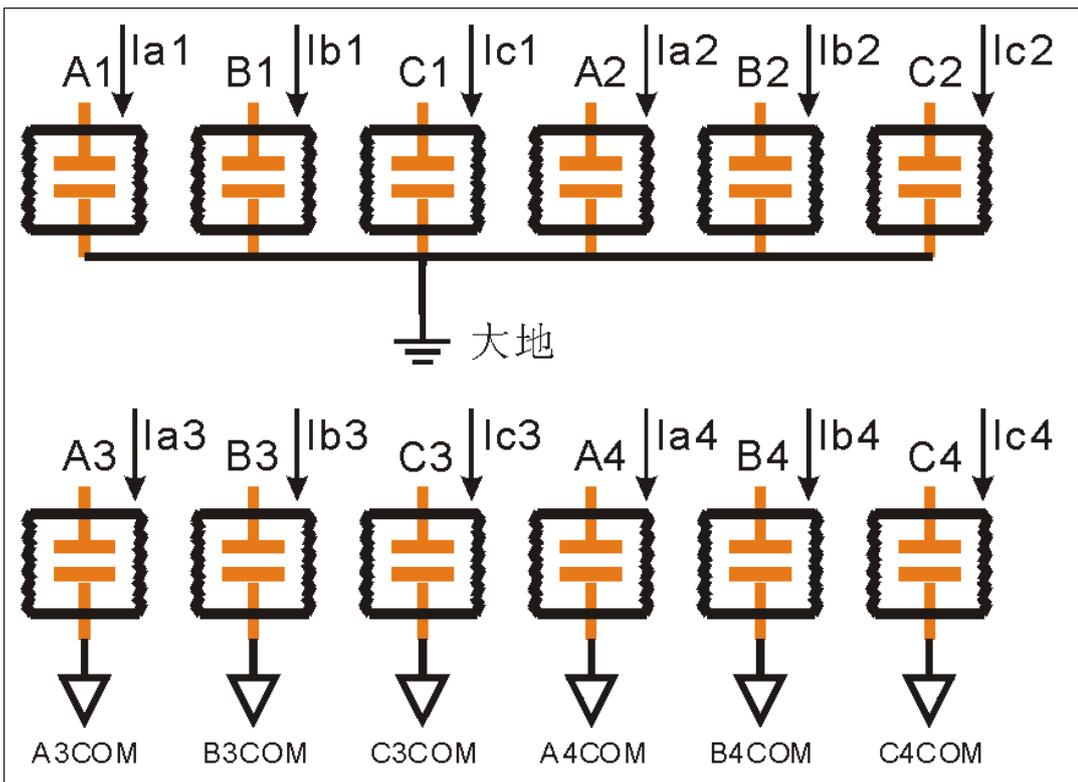
图 3.1 时间触头测量回路工作原理
