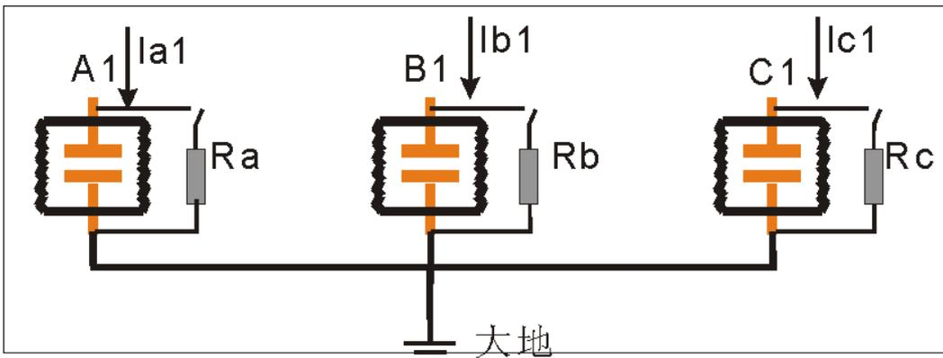
图 3.2 电阻触头测量回路工作原理
