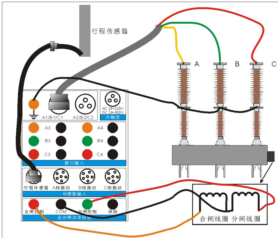
图 4.1 断路器合闸与分闸试验基本接线图
